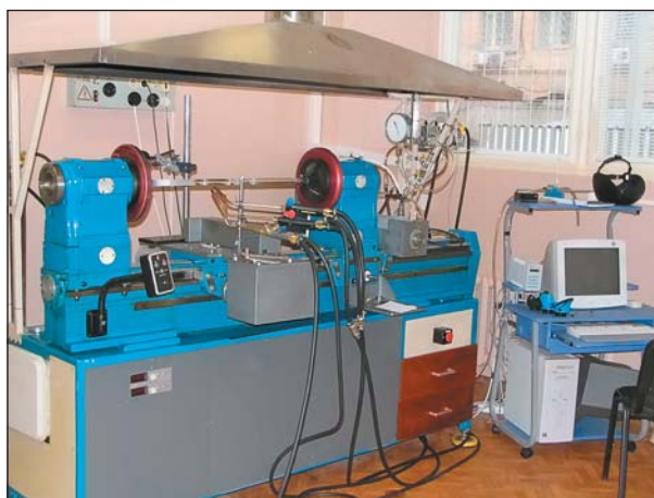
Рис.6. Установка для вытяжки оптоволоконна в лабораторных условиях.
