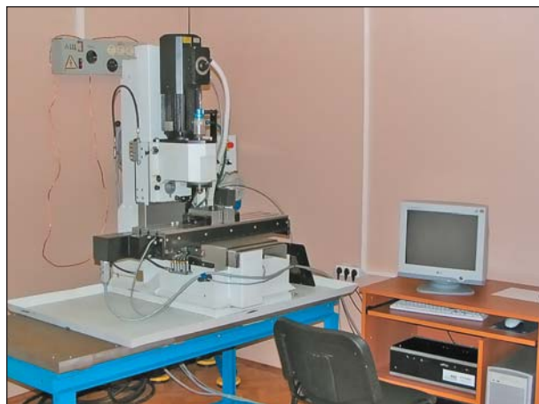
Рис.5. Установка для сверления и заготовка из плавленного кварца для вытяжки фотонно-кристаллического волокна.
